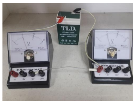
3 – rasm. Ikkita voltmetr yordamida tok manbaining EYK ni aniqlash tajribasining sxemasi va qurilmasi.
